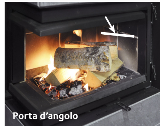
Per le cariche successive posizionare la legna secondo le istruzioni. Fare attenzione a non superare la fessura dell'aria secondaria segnalata in bianco nell'immagine.
