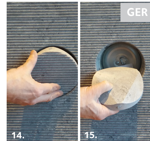
Den Aschenkasten entleeren. Die Rosette abheben. Die Richtung der Aschenklappe beachten!
